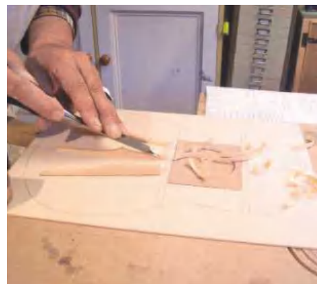
STEP 11. Scalloping the fan braces
